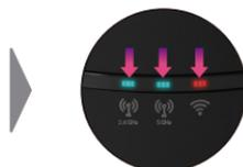
**Passo 4.** Agora, na parte traseira do seu **repetidor** mantenha o botão **Wi-Fi 5 GHz/WPS** pressionado **por 2 segundos e solte**. O **LED Wi-Fi 5GHz** irá piscar em **azul** durante 2 minutos.
